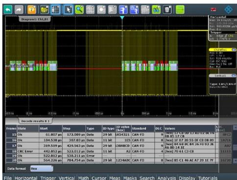
utilisateurs d'oscilloscopes R&S RTE et R&S RTO d'analyser les interfaces de ce type et de déclencher sur des détails de protocole. Le décodage matériel réalisé avec ces oscilloscopes permet de détecter très rapidement les erreurs, accélérant ainsi la vérification de la conception et des processus de mise en service pour les chipsets dotés d'interfaces CAN FD. Pour ses oscilloscopes, Rohde & Schwarz propose de
