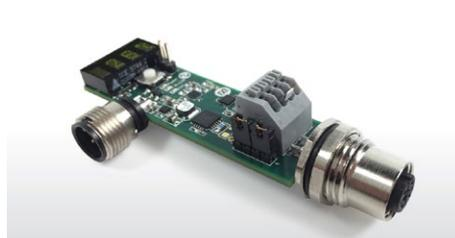
réduire la consommation, baisser les coûts et gagner de la place dans la réalisation de systèmes de commande et d'automatisation industrielles. Le frontal analogique très intégré de ce modèle de référence permet de mesurer la température, tout en détectant les ...
