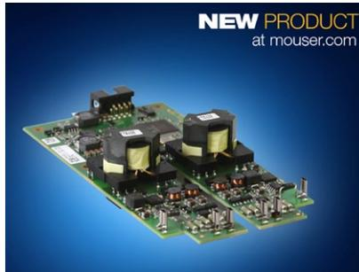
deux solutions fournissent une faible gigue de 1 ns (typique), une commande de grille de +20 V / -6 V, jusqu'à 125 kHz de fréquence de commutation et un courant de sortie atteignant +/- 20 A avec une forte immunité dV/dt. Elles ne demandent pas d'optocoupleurs et communiquent via une entrée RS422.
